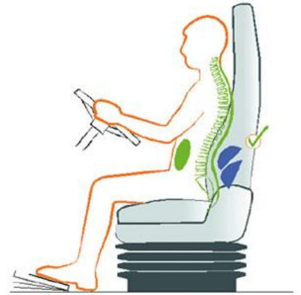
Système pneumatique intégré (IPS) avec un soutien lombaire et joues latérales ajustables
